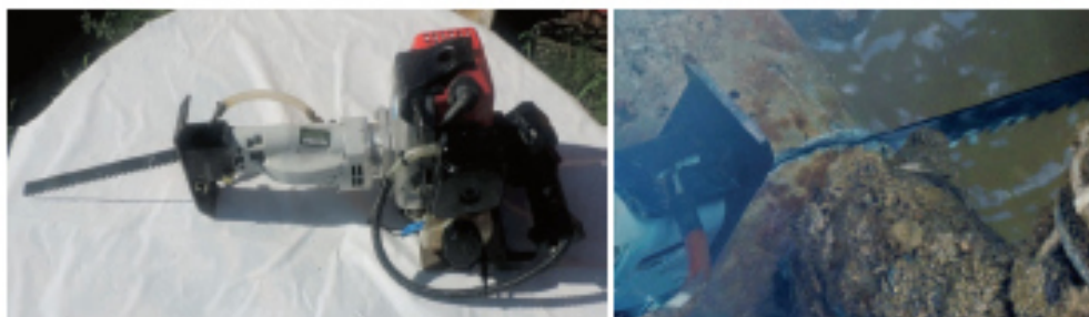
Figura 7 - Taglio di una tubazione mediante seghetto alternativo a motore (a scoppio) a bassa velocità di rotazione.
